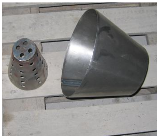
Figura 1.2.8 a, b - Model experimental simplificat de sistem modular de depoluare a gazelor industriale – Deflector și colector gaze poluate
