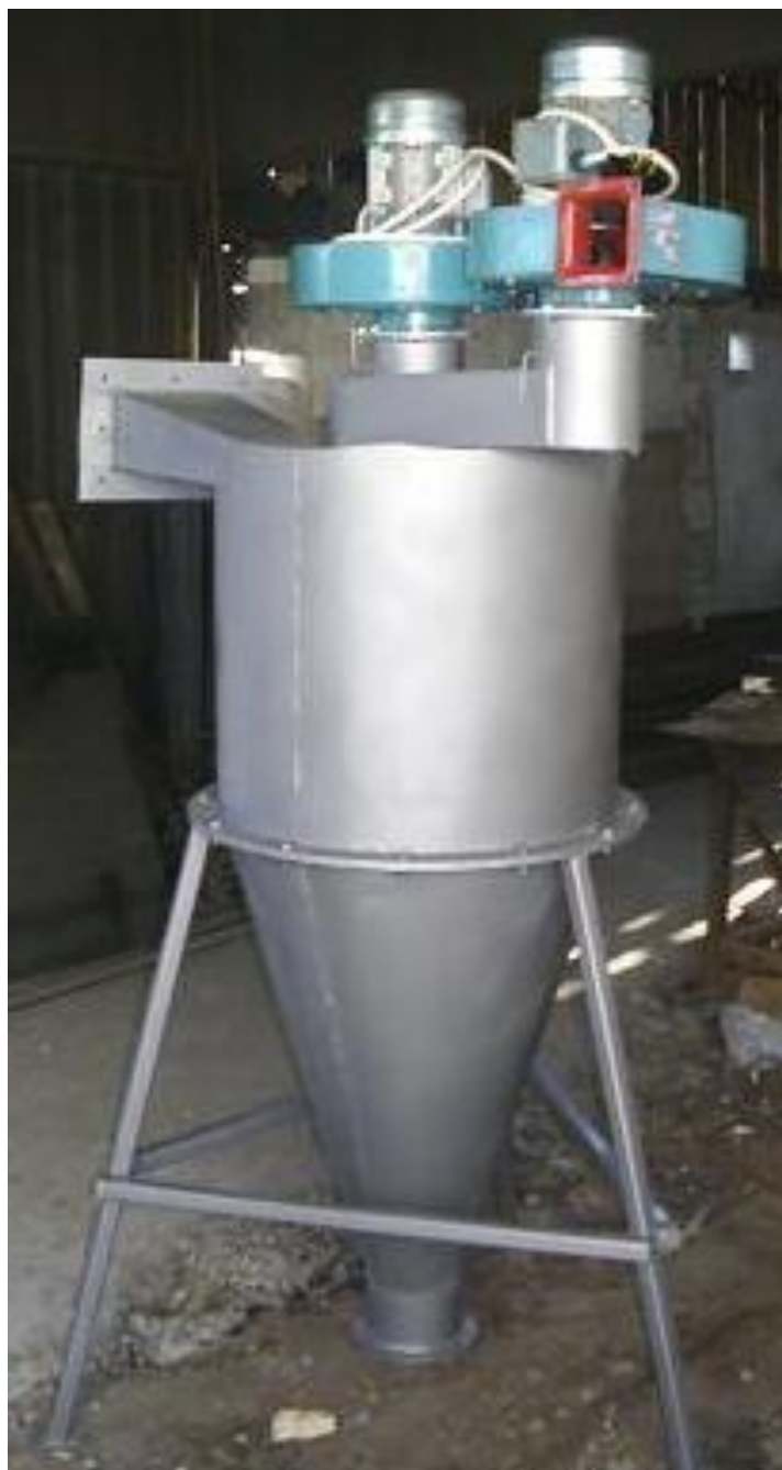
Figura 1.2.2 Model experimental simplificat de depoluare a gazelor industriale – Vedere de ansamblu 2
