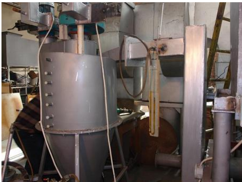
Figura 1.3.7 Model experimental simplificat – Racord admisie, măsurători presiuni
