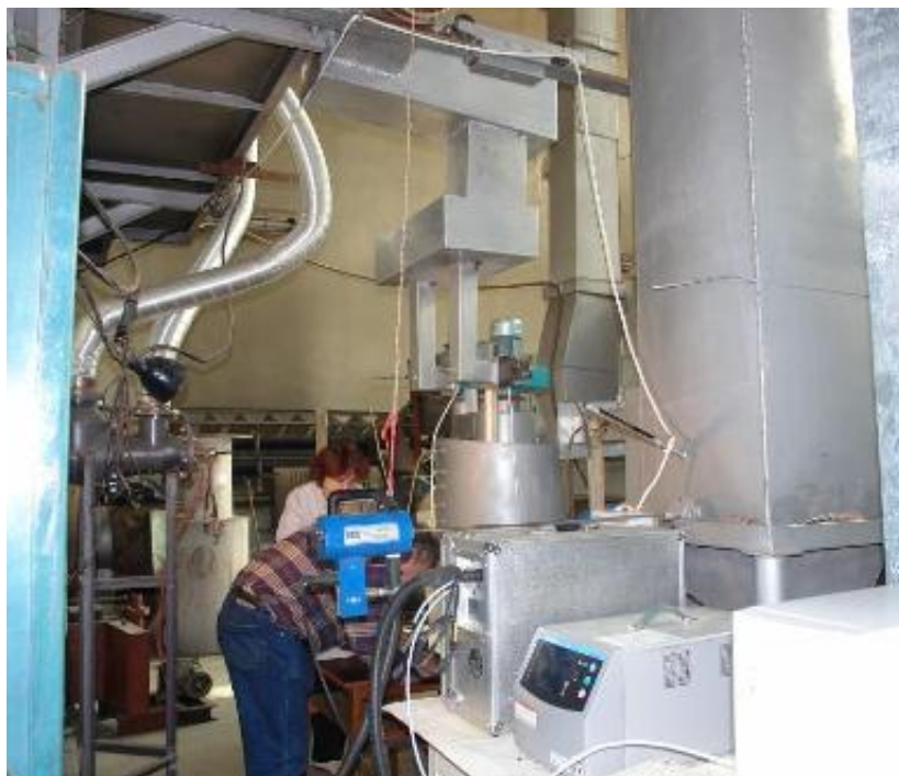
Figura 1.3.2 Model experimental simplificat – Vedere racorduri evacuare gaze curate și gaze poluate
