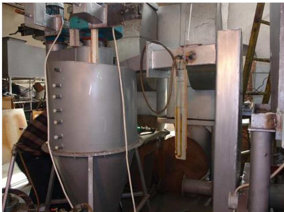
Figura 4.1.6 Model experimental simplificat – Racord admisie, măsurători presiuni
