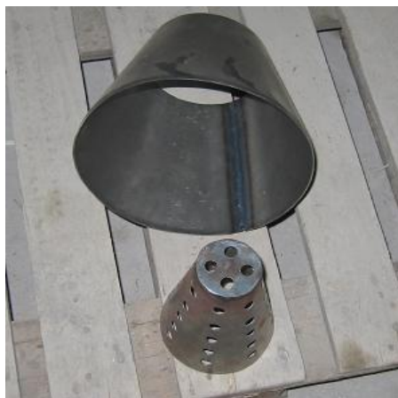
Figura 1.2.8 a, b - Model experimental simplificat de sistem modular de depoluare a gazelor industriale – Deflector și colector gaze poluate
