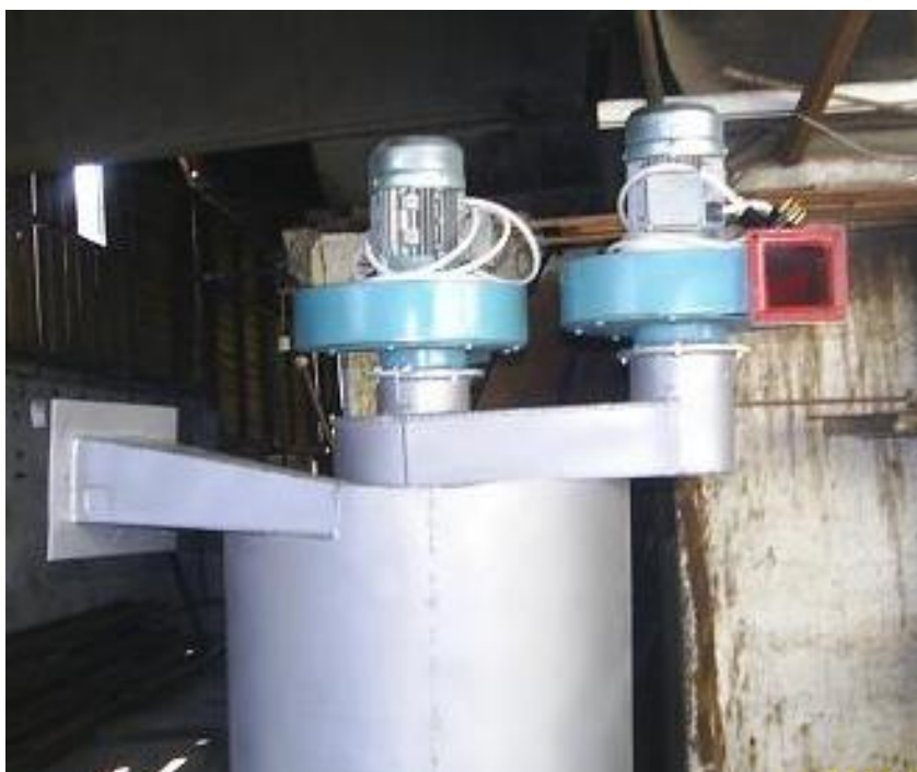
Figura 1.2.12 Model experimental simplificat de sistem modular de depoluare a gazelor industriale – Exhaustor și gură de evacuare gaze gaze curate
