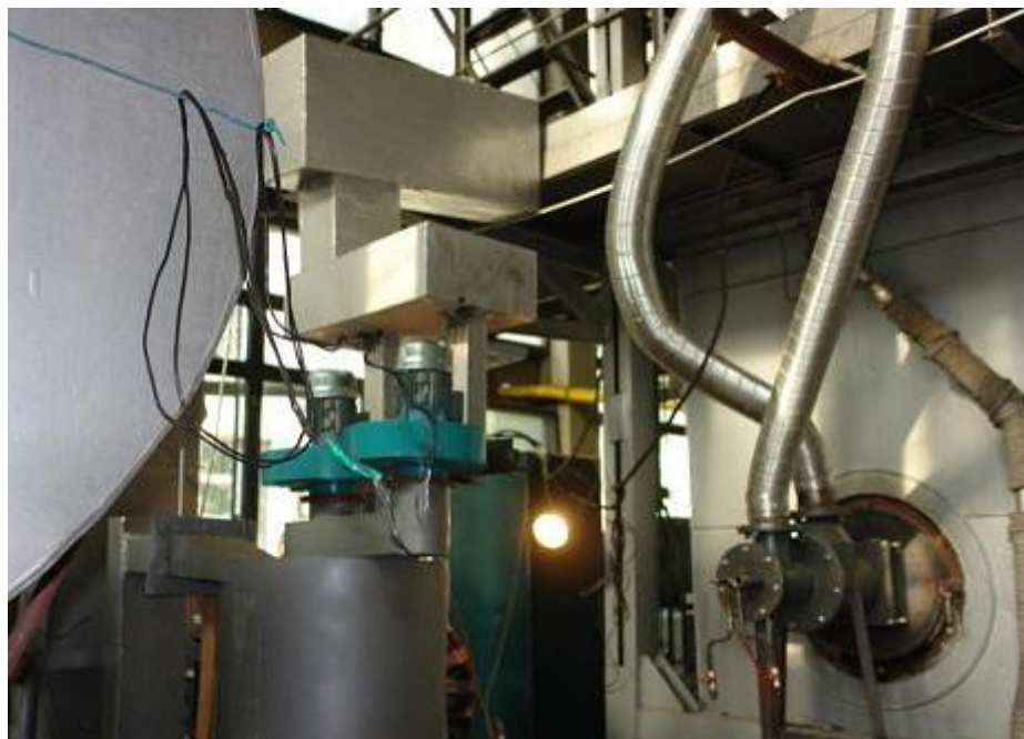
Figura 1.3.4 Model experimental simplificat – Racord evacuare gaze curate și gaze poluate
