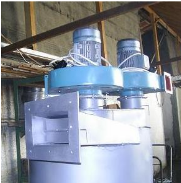
Figura 1.2.11 Model experimental simplificat de sistem modular de depoluare a gazelor industriale – Exhaustor și gură de admisie gaze
