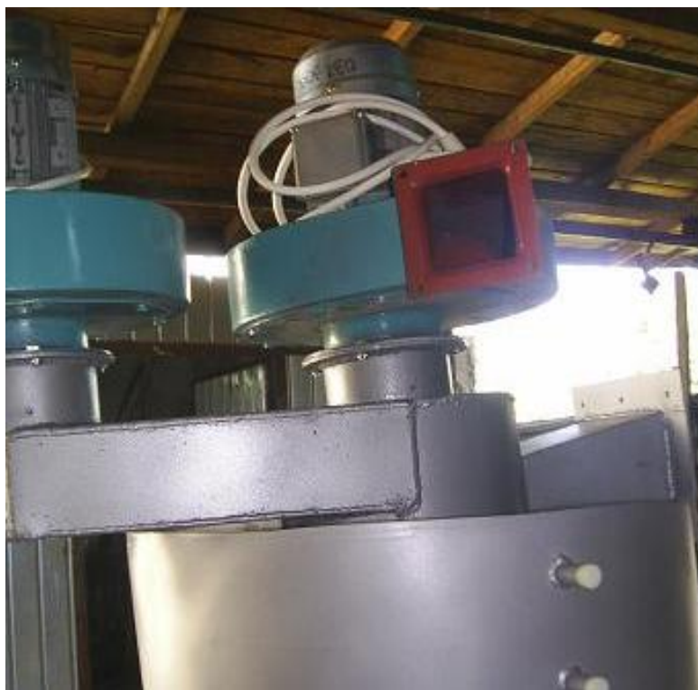
Figura 1.2.13 Model experimental simplificat de sistem modular de depoluare a gazelor industrial – Exhaustor și gură de evacuare debit rezidual gaze poluate
