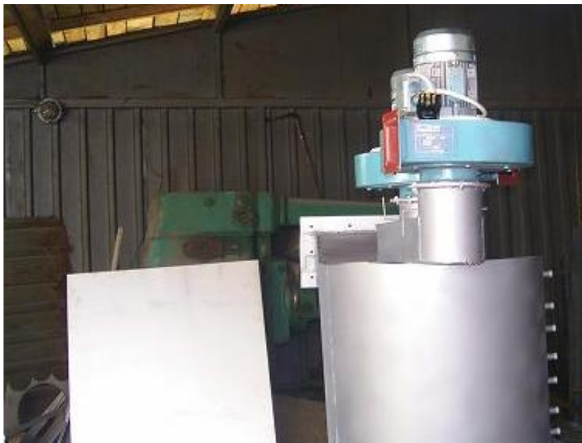
Figura 1.2.9 Model experimental simplificat de sistem modular de depoluare a gazelor industriale – Racorduri de măsură
