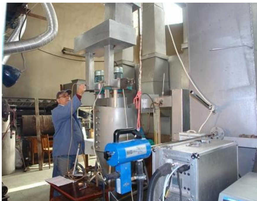
Figura 4.1.7 Model experimental simplificat – Măsurători concentrație CO 2 evacuări gaze curate
