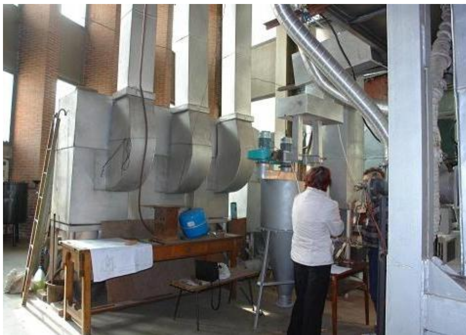
Figura 4.1.2 Model experimental simplificat – Vedere racorduri evacuare gaze curate și gaze poluate (Detaliu)
