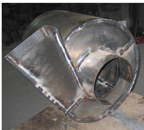
Figura 1.2.5 a, b - Model experimental simplificat de sistem modular de depoluare a gazelor industriale - Modul de separare
