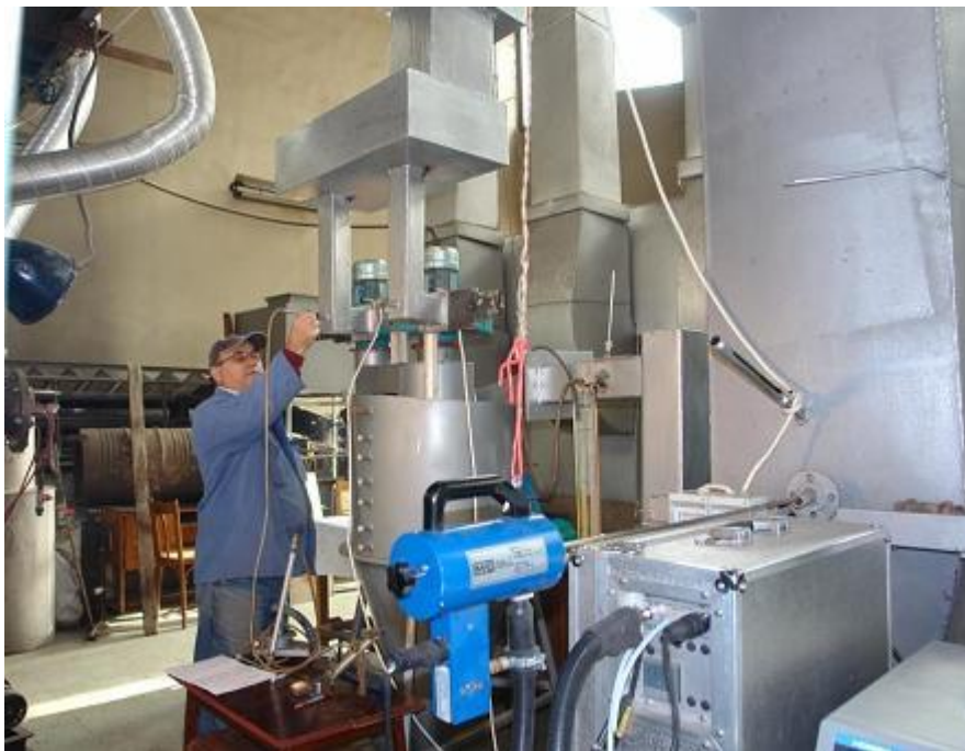
Figura 1.3.8 Model experimental simplificat – Măsurători concentrație CO 2 evacuări gaze curate
