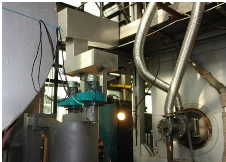
Figura 4.1.3 Model experimental simplificat – Racord evacuare gaze curate și gaze poluate
