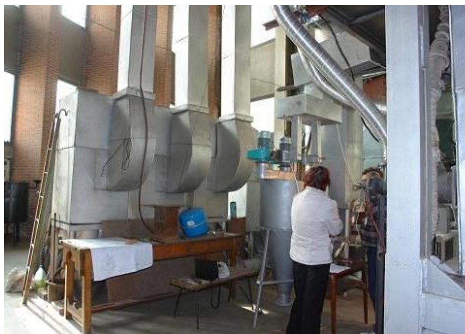
Figura 1.3.3 Model experimental simplificat – Vedere racorduri evacuare gaze curate și gaze poluate (Detaliu)
