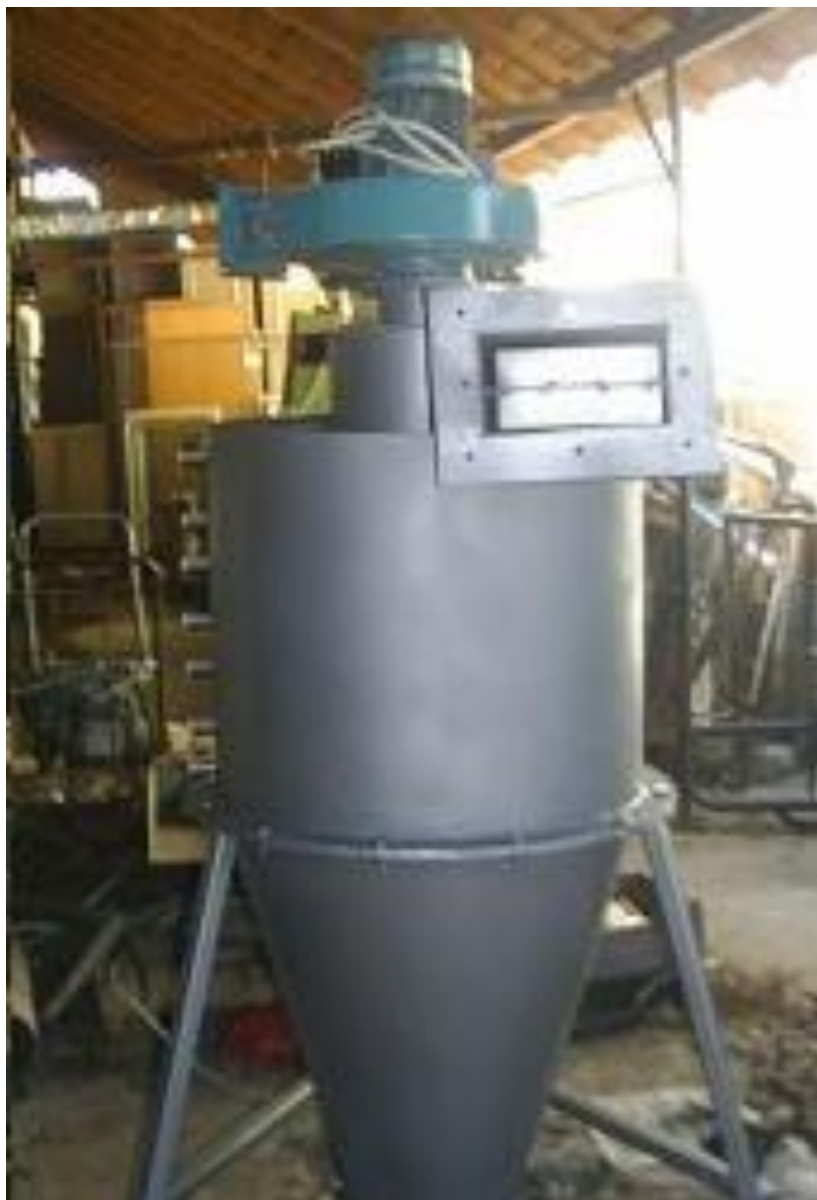
Figura 1.2.3 Model experimental simplificat de depoluare a gazelor industriale – Vedere de ansamblu 3
