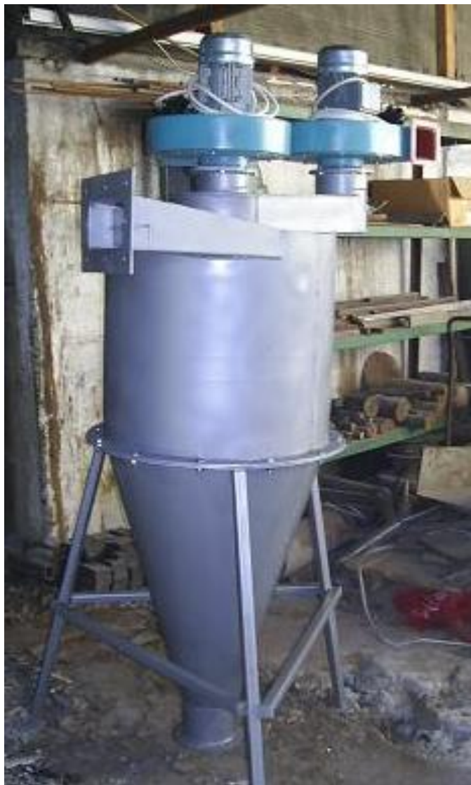
Figura 1.2.1 Model experimental simplificat de sistem modular de depoluare a gazelor industriale – Vedere de ansamblu 1
