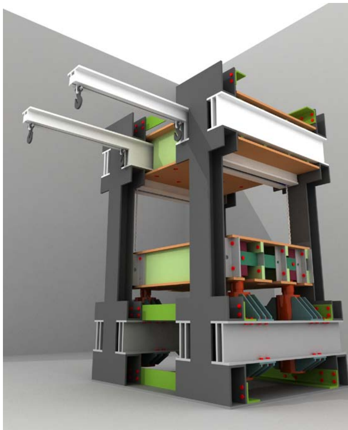
Figura 1.1. Instalație încercări experimentale – Vedere de ansamblu.
